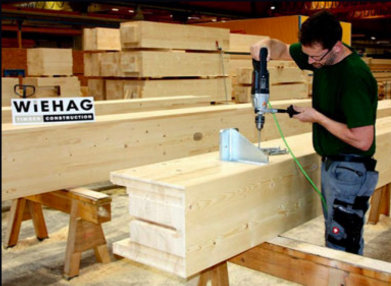
Altheim, Avusturya'daki Wiehag Timber Construction'da Glulam kiriş üretimi.
