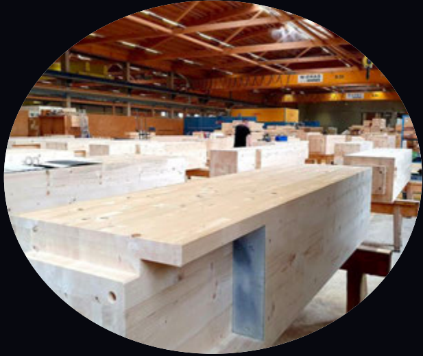
Altheim, Avusturya'daki Wiehag Timber Construction'da Glulam kiriş üretimi.
