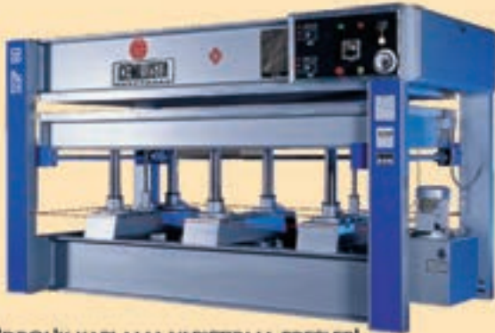
HİDROLİK KAPLAMA YAPIŞTIRMA PRESLERİ HYDRAULIC VENEER PRESSES
